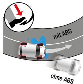
Bei einer Vollbremsung verhindert das ABS-System ein Blockieren der Räder, indem stets ein Maximum an Bodenhaftung aufrechterhalten wird.
